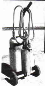
Vid tjänsteprov på flj gick allt bra, men när extratankar monterats på 35-an fick man kink på slangen till påfyllningsaggregatet. Om man inte var särskilt försiktig... Ändring är på gång.
